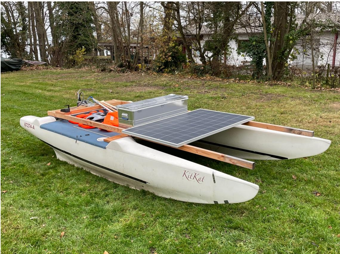
Abb. 1: Solarkatamaran mit Solarpanel und Kiste für Rettungsmittel, Akkus, etc.
