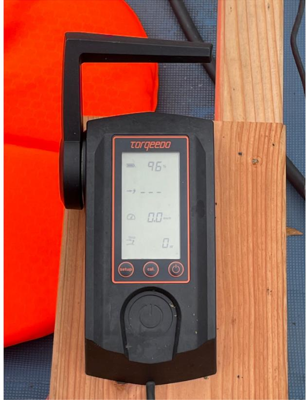
Abb. 4: Fahrregler (mit GPS)
