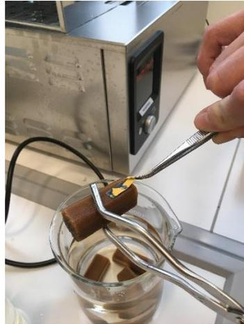
Abbildung: Prüfung des pH-Werts der Holzoberfläche
