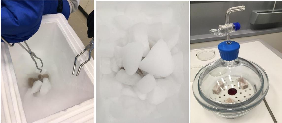
Abbildungen: Einfrieren der Holzstücke in Trockeneis und Trocknungsprozess im Exsikkator
